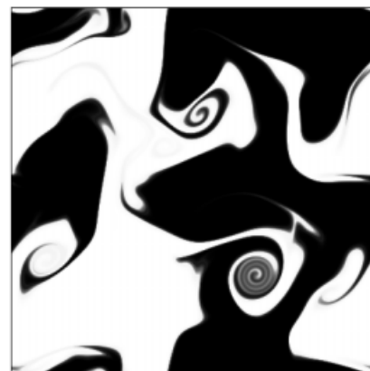
Abbildung 9. Zweidimensionale Simulation der Vermischung zweier Eduktströme unter turbulenten Bedingungen. [77]
